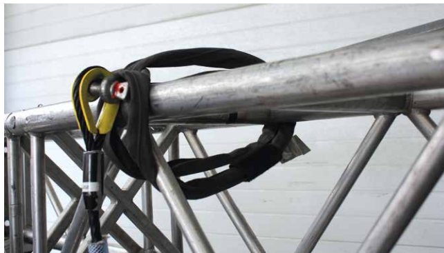
Foto 4: Grillete trabajando apoyado, mal uso
