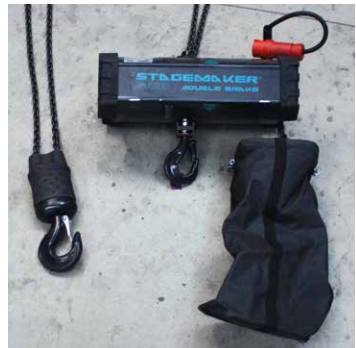
Foto 10: Polipasto eléctrico (motor).
