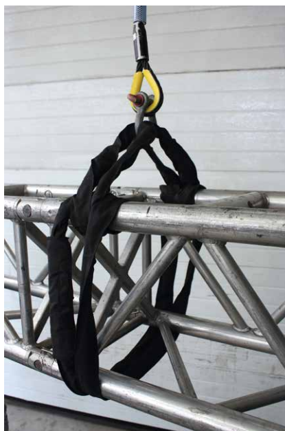
Foto 5: Eslingado de no más de 90°, buen uso
