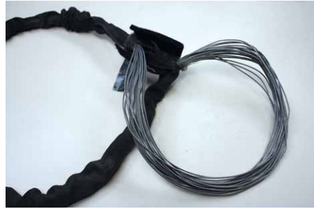
Foto 23: Construcción de eslinga tipo Gacflex
