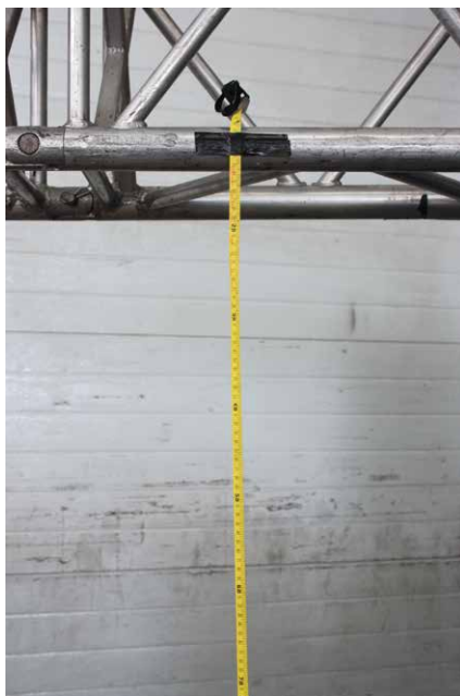
Foto 6: Cinta métrica para medir la posición final de un equipo
