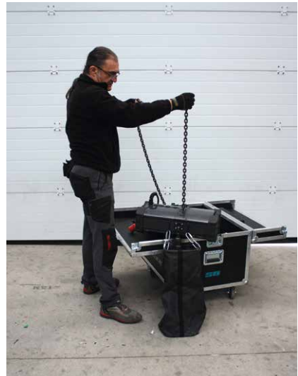
Foto 7: Forma correcta de sacar y/o guardar un motor
